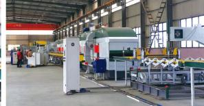
海路丰公司研发的高端保温板生产线为您提供高效的产业价值,我们的生产效率至少是同类产品的2倍以上,拥有国内外产品中最高的超值性价比。此条生产线能生产多品种多规格的保温夹心板材,包括聚氨酯夹芯板、岩棉夹芯板(聚氨酯封边),主要用于屋面夹芯板、墙面夹芯板和冷库板,厚度和宽度均可在设定范围内调整。
