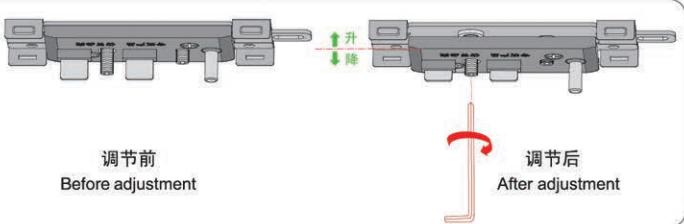
通过调节此螺丝，使阻尼拨动件升降，防止移门跳动
