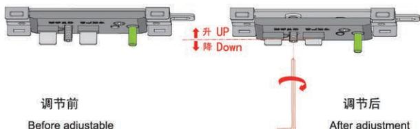
通过调节此螺丝，使挡件斜柱升降，从而跟阻尼挂钩充分接触
