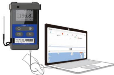
2. 长按“蓝牙打印按键”设备将自动连接配套的鼎为Frigga蓝牙打印机(详情见7.蓝牙打印),并打印报告。
