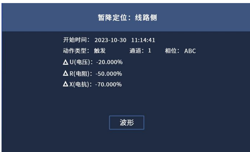
图 4.25(a) 电压暂降源定位-线路侧
