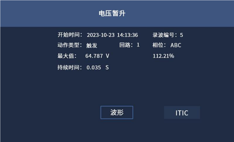
图 4.23(a) 电压暂升事件
