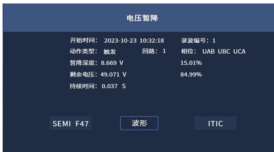
图 4.22(a) 电压暂降事件
